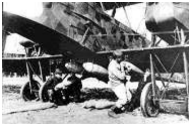
Installation des bombes sous un bombardier allemand Gotha
